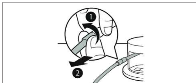
Sl. 6.3 Odstranjevanje vakuumske cevi iz spojke
