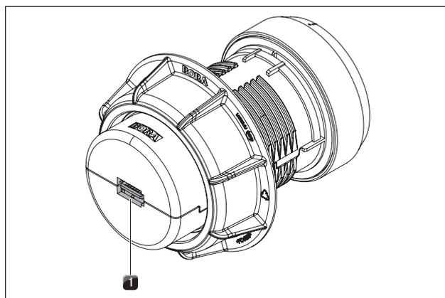
Fig. 5.18 Connecteur du bouton de commande à l'arrière
