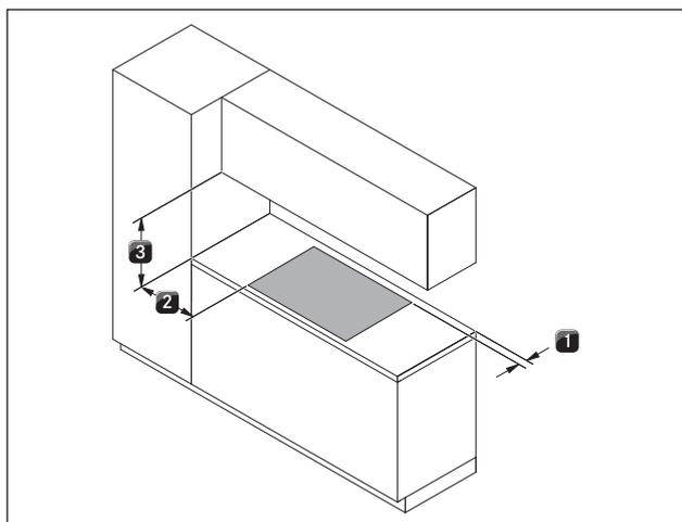
Fig. 5.17 Distances minimales en montage à 180°
