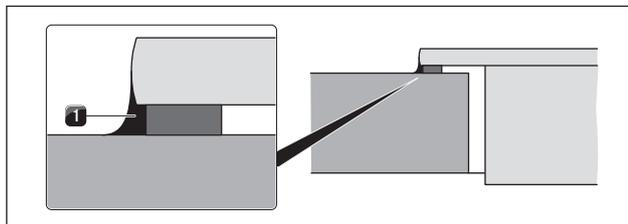
Fig. 5.26 Joint en silicone en montage en saillie
