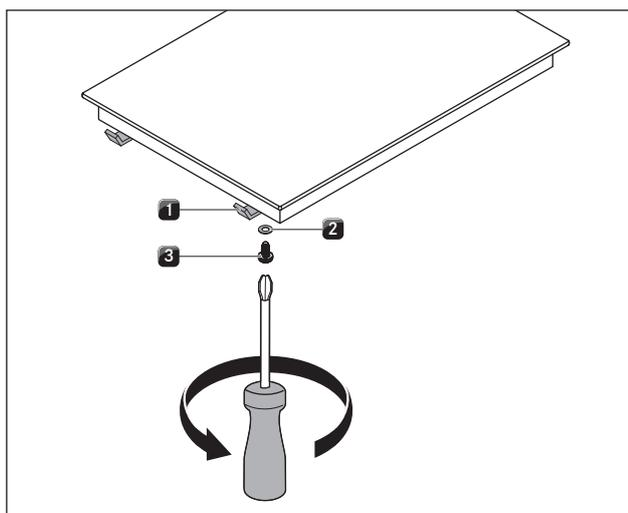
Fig. 5.16 Pattes de fixation
