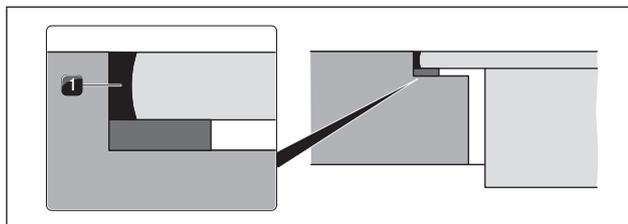
Fig. 5.25 Joint en silicone en montage affleurant
