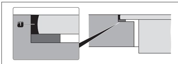
Fig. 5.29 Joint en silicone en montage affleurant
