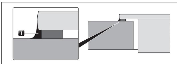
Fig. 5.30 Joint en silicone en montage en saillie
