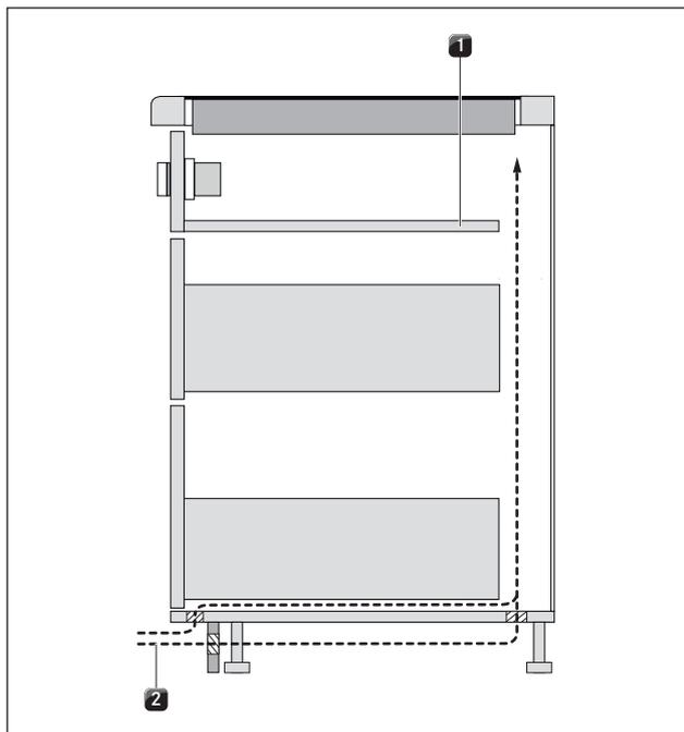
Fig. 5.3 Alimentation en air dans le socle
