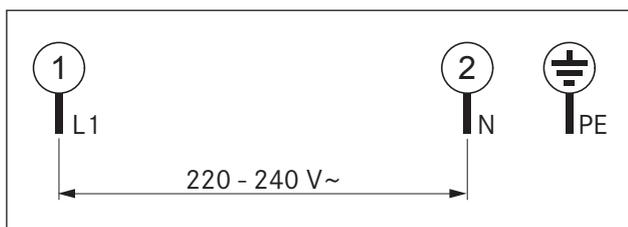
Fig. 5.22 Schéma de raccordement 1 phases
