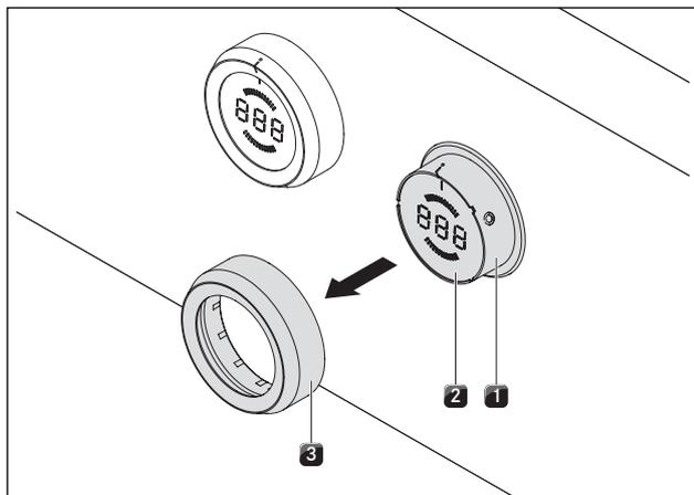
Fig. 7.5 Retrait de la bague du bouton rotatif
