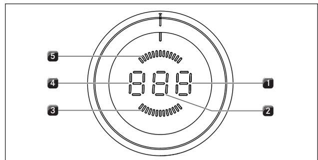
Fig. 4.4 Éléments d'affichage du bouton de commande
