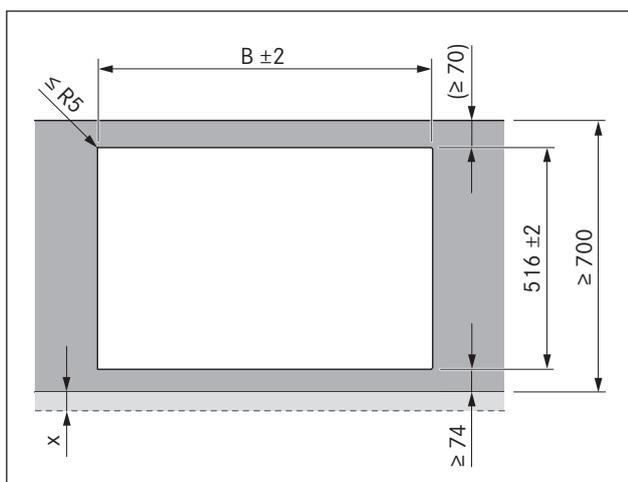
Fig. 5.5 Dimensions de découpe montage par le dessus
