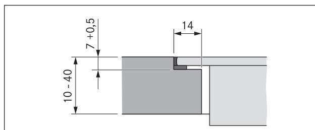
Fig. 5.4 Dimension de rainure pour montage affleuré
