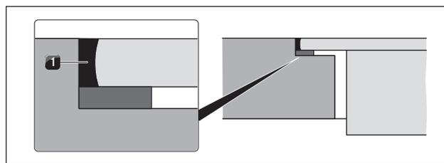
Fig. 5.23 Joint en silicone en montage affleurant
