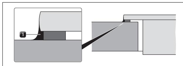
Fig. 5.24 Joint en silicone en montage en saillie
