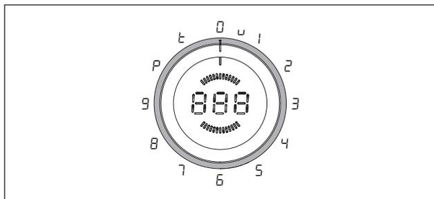
Fig. 6.1 Configuration des bagues pour bouton rotatif
