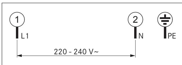
Fig. 5.22 Schema di collegamento monofase
