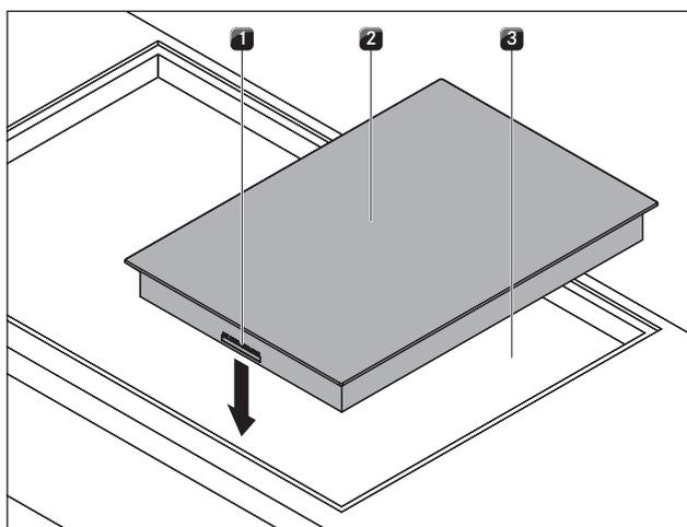
Fig. 5.14 Inserire il piano cottura
