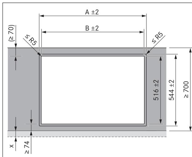
Fig. 5.3 Dimensioni intaglio montaggio a filo piano
