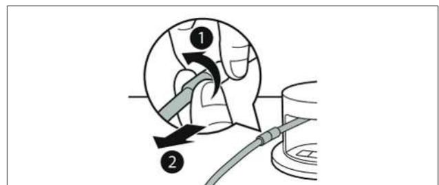
Fig. 6.3 Separar a mangueira de vácuo do acoplamento
